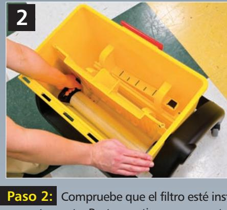
**Paso 2:** Compruebe que el filtro esté instalado correctamente. Basta con tirar suavemente del filtro. Si no se puede levantar fácilmente, está fijado con firmeza. De lo contrario, simplemente saque el filtro levantándolo y luego vuelva a colocarlo poniendo la boquilla en el agujero y presionando firmemente hacia abajo.
